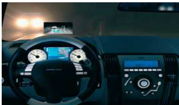
• obrázok 28 Systém nočného videnia zobrazený na čelnom skle
