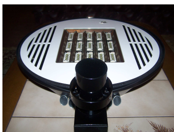
první prototyp svítidla osazený 15-ti bloky LED, každý s příkonem 8W
